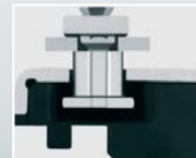
Achtkant-Sicherheitsverschlussbolzen im Sicherheitsschließblech fest verankert
