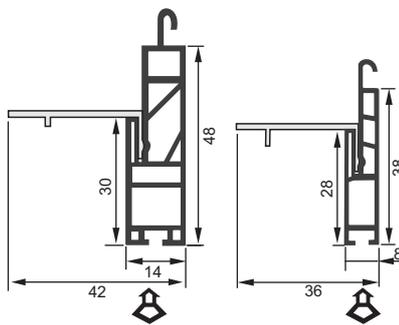
Aluhohlendleisten Ausführung mit Anschlagstopperrn in 28, 40 oder 60 mm rund.
