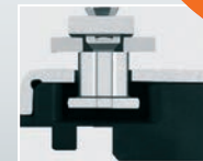
Achtkant-Sicherheitsverschlussbolzen im Sicherheitsschließblech fest verankert
